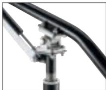
Optimaler Anpressdruck an die Schleiffläche durch Gasdruckfeder
