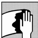
Entfernen Sie vor dem Auftragen des Decklacks jegliche Oberflächenverunreinigung unter Verwendung entsprechender Oberflächenreiniger.
