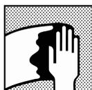
Oberflächenreinigung; Entfernen Sie vor dem Auftragen von Autosurfacers HB jegliche Oberflächenverunreinigung unter Verwendung entsprechender Oberflächenreiniger.
