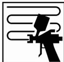
Eine volle Schicht über die komplett geschliffene Oberfläche auftragen. Anschließend eine zweite und dritte Schicht innerhalb der vorherigen Schicht auftragen. Bei einer Lackierung des ganzen Teils, 2-3 Schichten über das gesamte Teil auftragen, abhängig von der gewünschten Schichtdicke.
