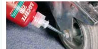
Mit normalen Handwerkzeugen nur sehr schwer demontierbar, eventuelles Erwärmen erforderlich. Zum Sichern von bereits montierten Schrauben, an Mess- und Regelgeräten, Vergaserschrauben.
