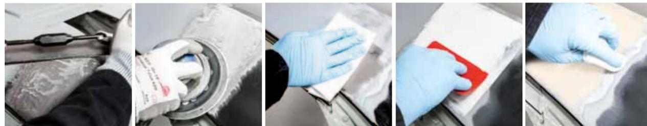
Bearbeitung des ausgehärteten Schwemzinnns mit Karosseriehobel
