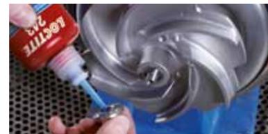
Mit normalen Handwerkzeugen demontierbar, eventuelles Erwärmen erforderlich. Für Schrauben in Anlagen, die nicht regelmäßig demontiert werden müssen; für Gewinde bis M50.
