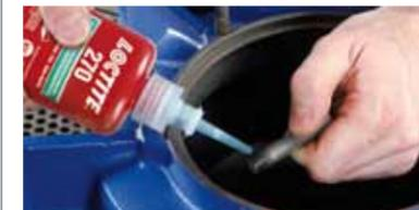
Mit normalen Handwerkzeugen nur sehr schwer demontierbar, eventuelles Erwärmen erforderlich. Für Schrauben in Anlagen, die nicht regelmäßig demontiert werden müssen – Schwermaschinen, Motor- und Pumpenlager, Stiftschrauben; für Gewinde bis M50.
